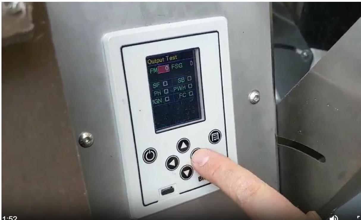
1. FM – veuillez entrer environ 20 à 30 dans le champ. Il s'agit des secondes nécessaires à l'exécution du test du ventilateur. Vous l'entendrez fonctionner ou non.
